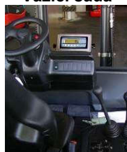
KPZ 39 Váha pro hydraulické vysokozdvíže zařízení
